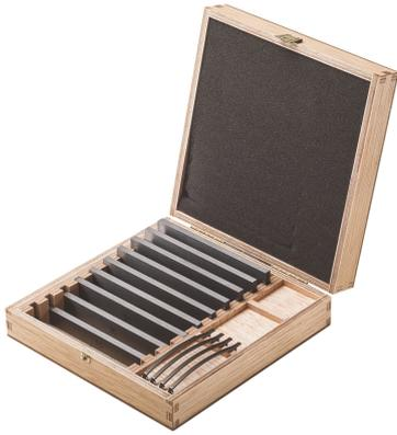
A37 **Werkstück-Auflageleisten Cliparc**, Set im Holzkasten mit 10 verschiedenen Leistenpaaren und 4 Spannbugeln
