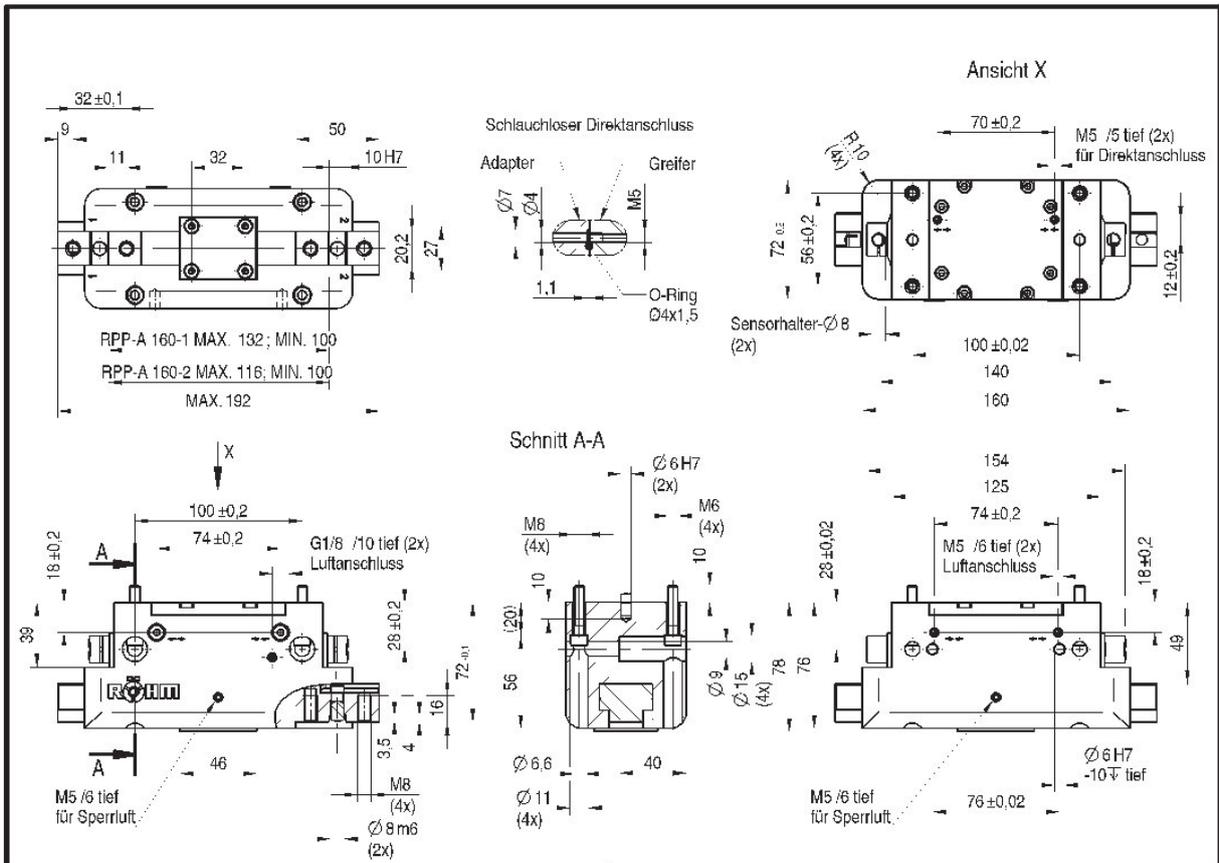
Typ GA/GI mit Greifkraftsicherung
