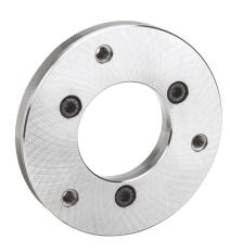
C 15 Stahl-Zwischenflansche mit zylindrischer Zentrieraufnahme DIN 6353 für 3-Backen-Futter Befestigung von vorne nach ISO 702-1 (DIN 55026/55021) und ASA B 5.9 A1/A2 mit metrischen Befestigungsschrauben (spindelseitig)
