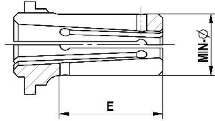
C 18 Spannhülse Ausführung B - vulkanisiert (gegen Schmutz und Späne geschützt)
