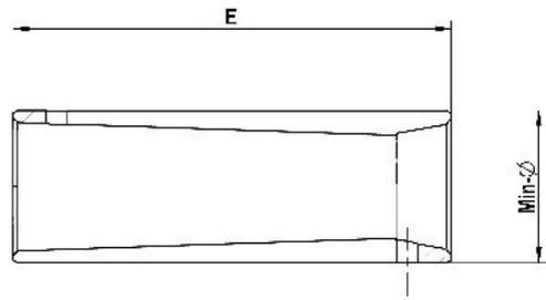
C 18 Spannhülse Ausführung E - für Grunddorn MZE
