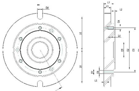
A09 Grundplatte für CAPTIS-M und Drehfutter mit **zylindrischer Zentrieraufnahme** DIN 6350
