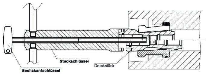
C 15 **Steckschlüssel** für Druckstück-Einschraubmontage
