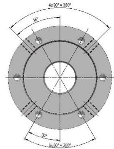
C 15 Anbauflansch mit Einbauspannsatz HSK-C gewuchtet und mit zentraler Kühlmittelzuführung (außer Größe 25)
