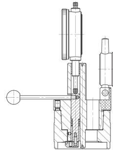
C 15 Messvorrichtung zur Messung der Einbaukontur (Spannschräge) an Spindeln für automatische HSK-Spannsätze
