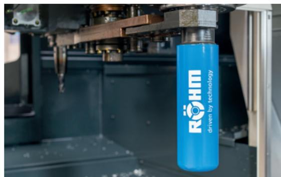
Damit dies der Vergangenheit angehört, hat RÖHM das Lubritool® Schmierwerkzeug entwickelt. Von der Maschinensteuerung über den richtigen Zeitpunkt informiert, wird das Lubritool® direkt aus dem Werkzeugmagazin automatisch eingewechselt und versorgt den Spannsatz binnen Sekunden mit der idealen Schmiermenge.
