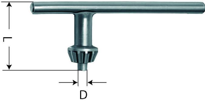
Werkzeuggruppe A01 Schlüssel mit **DIN-Verzahnung 6349** für Zahnkranz-Bohrfutter
