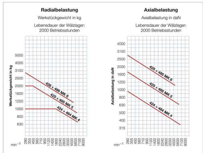
A06 Heavy speziell für **hohe Belastungen bei hohen Drehzahlen** Körper gehärtet und geschliffen - Spitzenwinkel 60°
