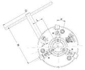
Das Massenträgheitsmoment wurde ermittelt mit Grundbacken, ohne Aufsatzbacken und ohne Flansch Durchgang (Maß C) kann aufgebohrt werden (gegen Aufpreis)
